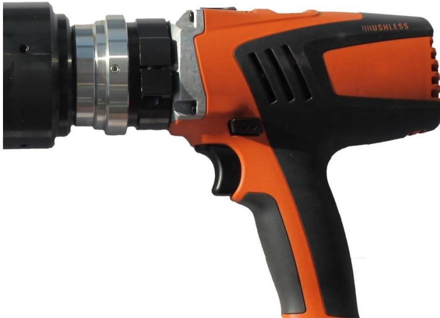
Der rautenförmige Drehrichtungsumschalter ist auf jeder Seite mit dem Pfeil für die jeweilige Drehrichtung gekennzeichnet. Durch Drücken des Drehrichtungsumschalters wird die Drehrichtung geändert, siehe Bild. Achten Sie darauf, dass der Drehrichtungsumschalter ganz links oder rechts fest eingerastet ist. Ändern Sie die Drehrichtung nur bei Stillstand.
