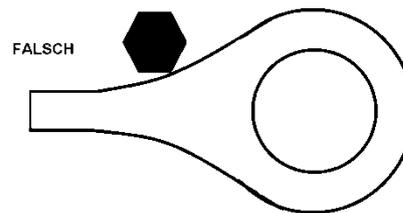
**Das Gerät niemals vorne an der Nuss oder am Drehmomentaufnehmer halten. Es besteht die Gefahr von Quetschungen und anderen Verletzungen! Fassen Sie auf keinen Fall zwischen Drehmomentaufnehmer und Abstützpunkt.**
